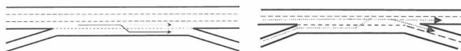
Figura 234. Dos ejemplos de tramos de trenzado a un solo lado, en rampa y extendido
